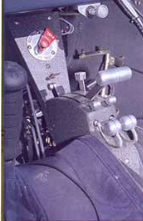
Le due caratteristiche levette dei freni differenziali sono dotate di manettini di blocco per lo stazionamento
